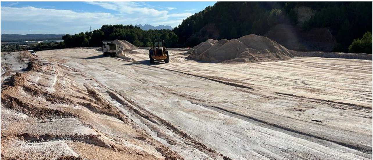
Una fressadora arrenca el mineral des de la superfície ICL
